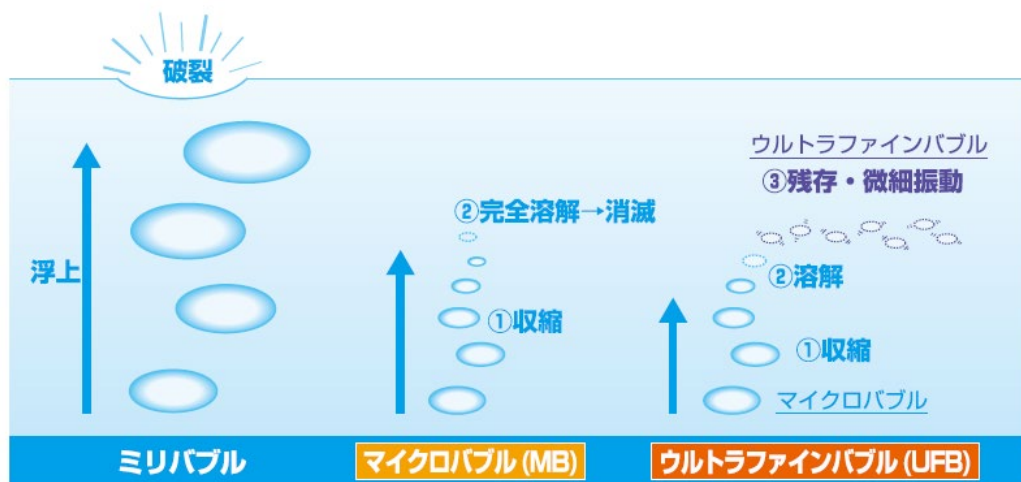
図1 ファインバブルの生成プロセス
